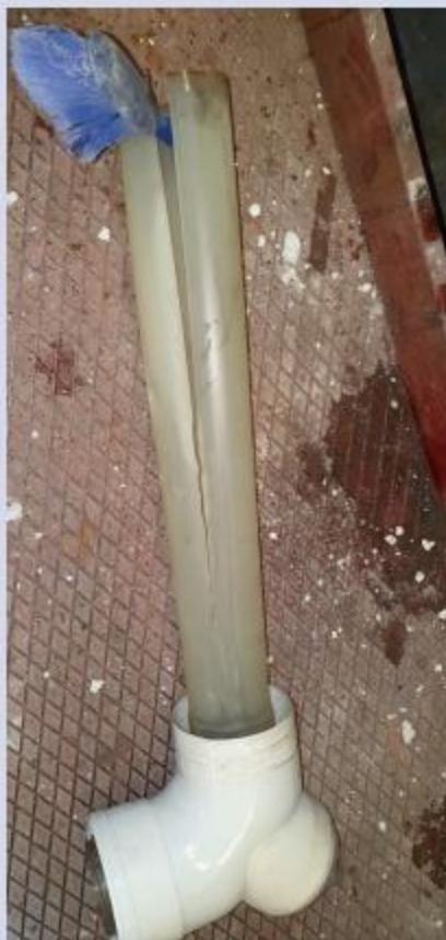
prasklá plast koncentrika, kotel se dusil
