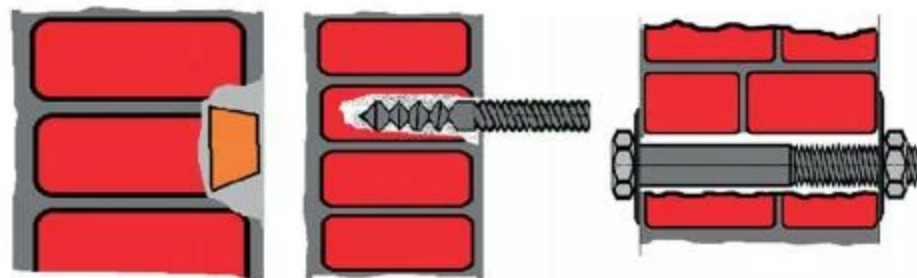
Zazdívaný špalík, temovaná ocelová kotva, průchozí kotva
