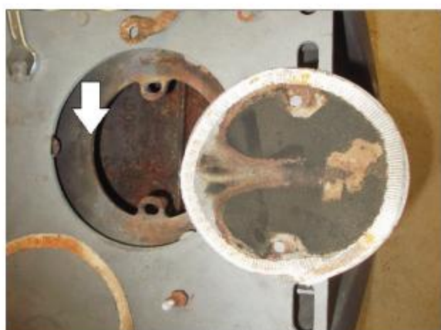
Přetopení způsobilo prohnutí stropu spalovací komory a následně přisávání falešného vzduchu do topidla. Ocelový plášť byl vyrovnán a po výměně těsnění bylo víčko vráceno na původní místo.
